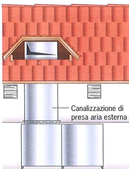
11 Forte di Bard, sezione trasversale sottocentrale condizionamento piano sottotetto.
